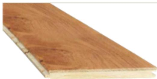
表層に厚み約3mmの無垢単板を使用し、中間層と下層にも木材を配した三層構造です。無垢に比べて収縮・膨張が起こりにくい構造です。
